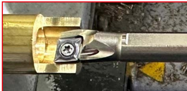
Dimple Bar Diámetro de mecanizado mínimo de 10 mm
